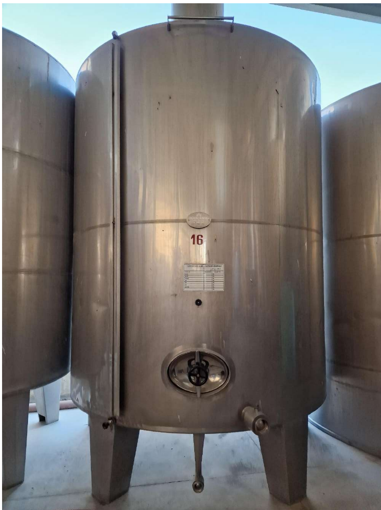
42- SERBATOI DA 170 HL
