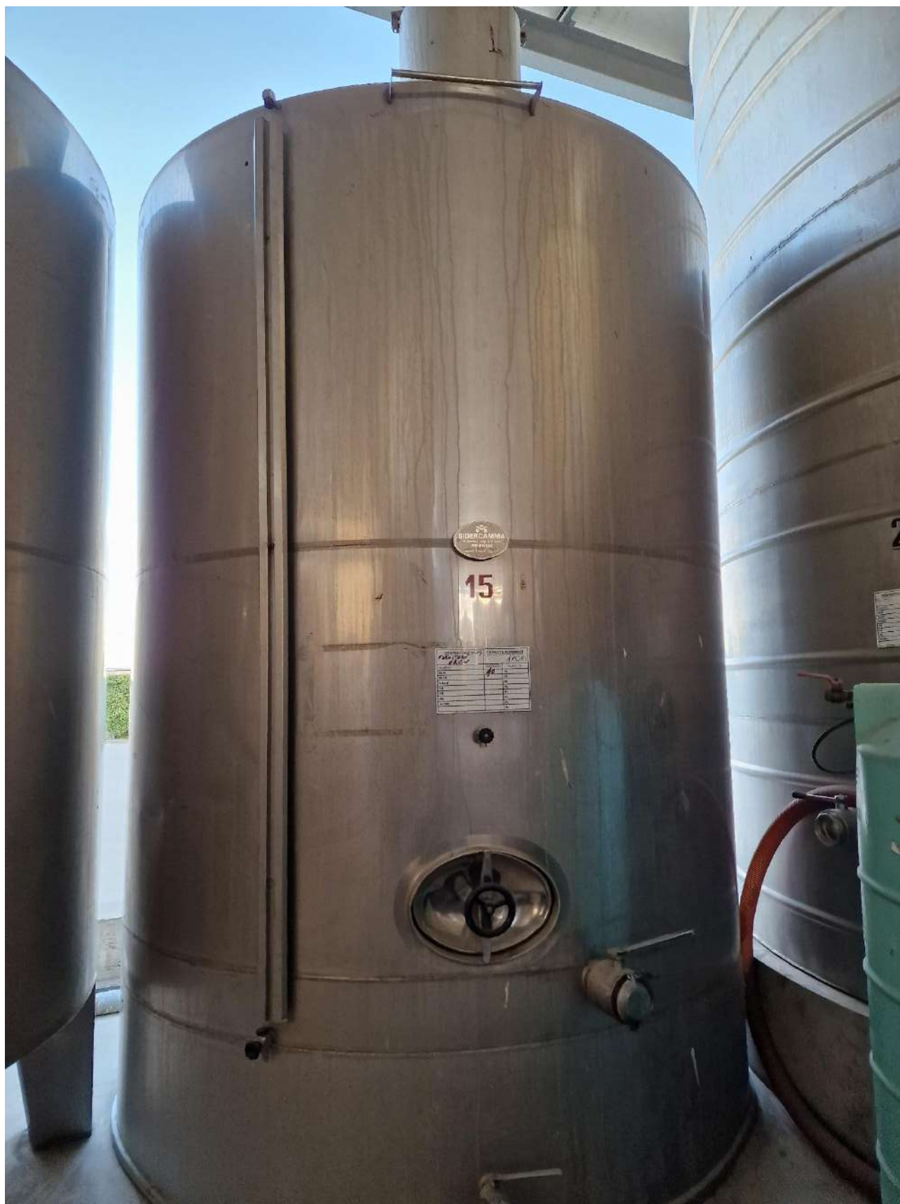
42- SERBATOI DA 170 HL
