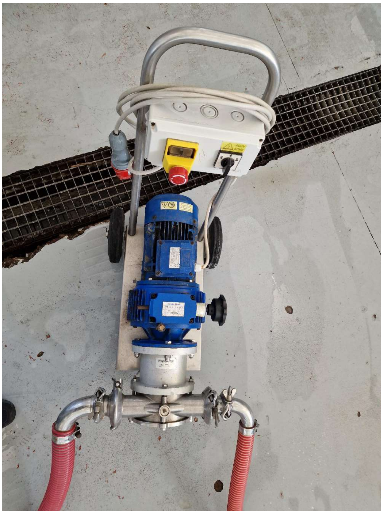
30- ELETTOPOMPA INVERTER PER TRAVASI
