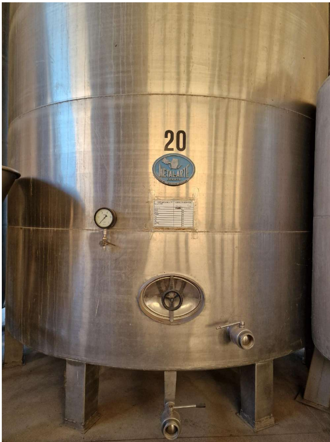
43- SERBATOI DA 600 HL
